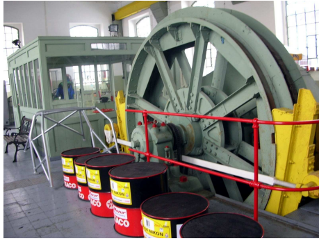
Rys. 3. Koło pędne maszyny wyciągowej szybu „Teresa” z 1923 r., stan obecny
