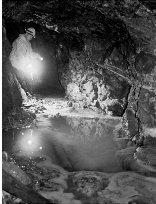
Rys. 6. Szyb prowadzący do dolnego, zatopionego poziomu kopalni
