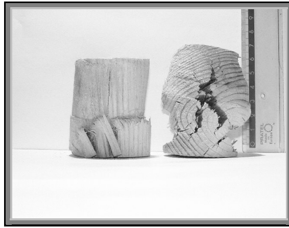
Rys. 4. Próbkę sosny zniszczona w wyniku badań wytrzymałościowych
