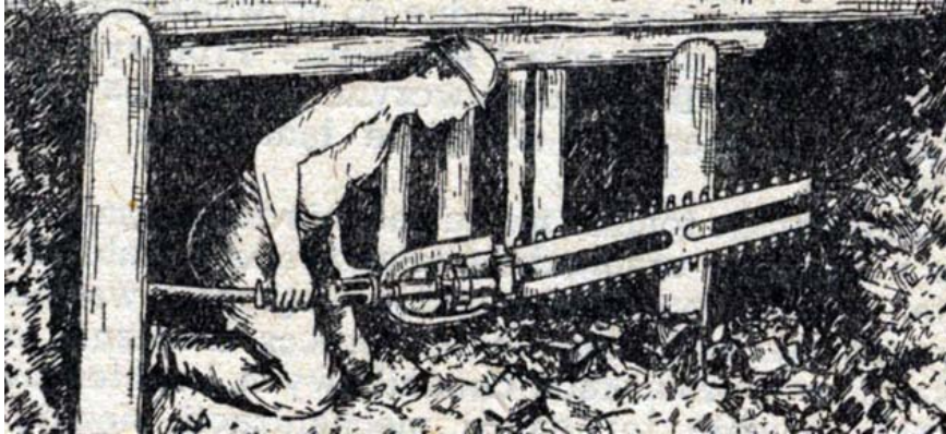
Rys. 6. Piła węglowa poruszana sprężonym powietrzem
