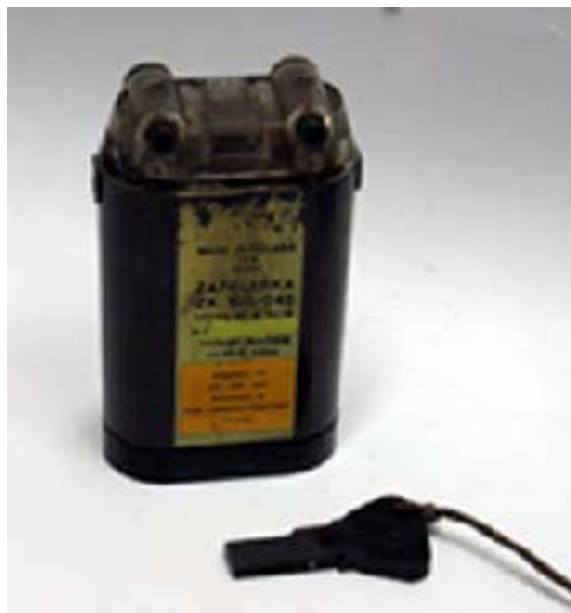
Rys. 5. Zapalarka kondensatorowa ZK 100 Fig. 5. ZK 100 Condenser Exploder
