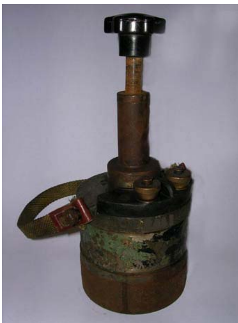
Rys. 3. Zapalarka magnetodynamiczna ZW 2S (Barbara 3)
