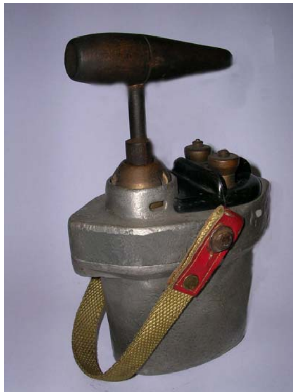
Rys. 2. Zapalarka dynamoelektryczna typ DAMSK Fig. 2. Dynamometer Exploder DAMSK type
