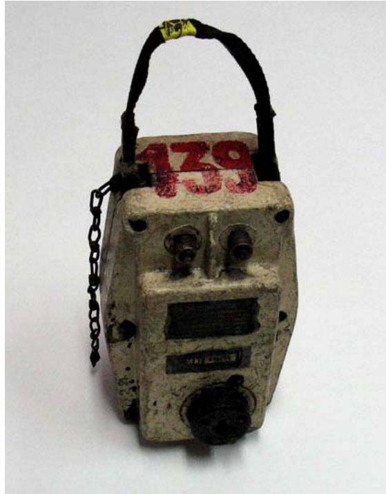
Rys. 4. Tranzystorowa zapalarka kondensatorowa typ TZK 100G
