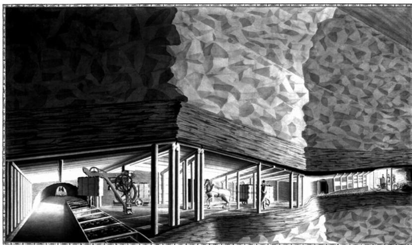
Rys. 6. Widok portu załadunkowego i dźwigu do ładowania skrzyń z węglem na łodzi w rejonie pokładów poziomych
