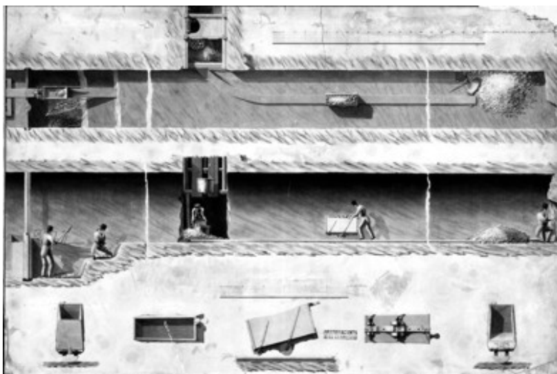
Rys. 3. Schemat drażenia Głównej Kluczowej Sztolni Dziedzicznej Fig. 3. A diagram of the adit boring the Main Hereditary Key Adit
