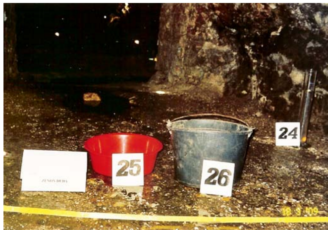
Rys. 10. Pomiar objętości skraplającej się wody
