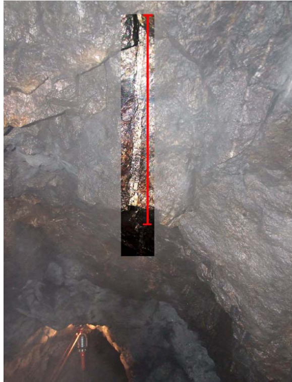
Rys. 7. Kruszconośna żyła barytowa w stropie wyrobiska sztolni
