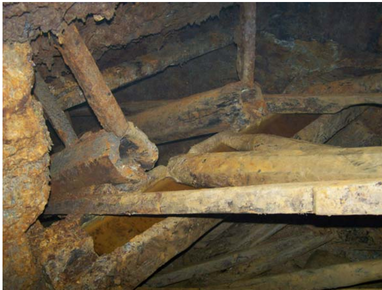
Rys. 4. Elementy średniowiecznej maszyny odwadniającej (średnica rury około 40cm) (fot. W. Mišta)
