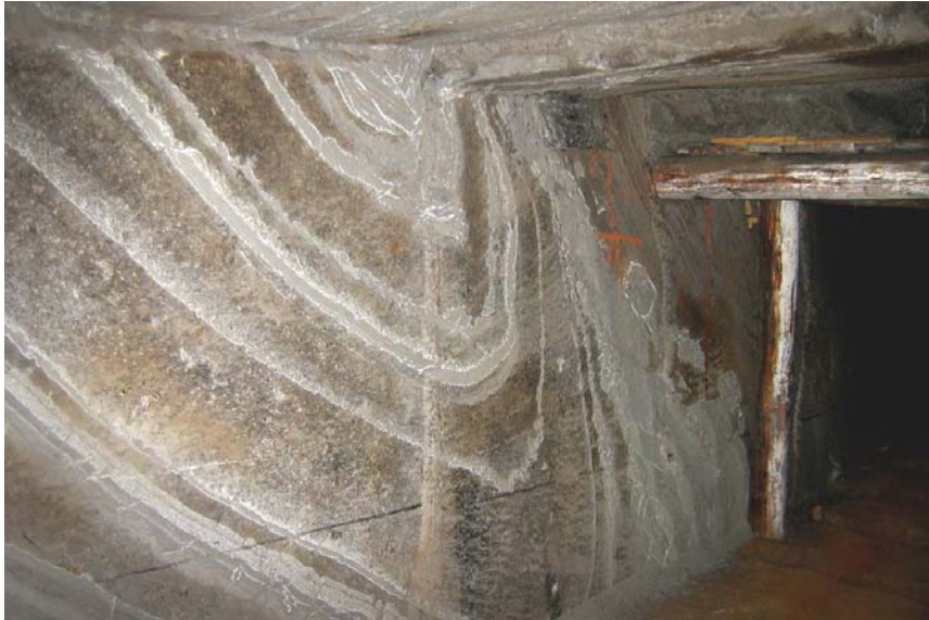
Ryc. 6. Odślonięcie synklinalnego fałdu soli spiżowych poprzedzielanych iłowcami anhydrytowymi w podłużni Franciszek (fot. J. Przybyło)
