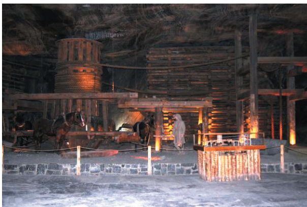
Rys. 7. Rekonstrukcja kieratu saskiego w komorze Kazimierza Wielkiego KS „Wieliczka”
