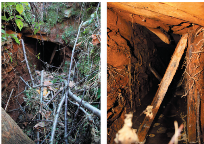
Rys. 17. Wlot sztolni odwadniającej kopalnię „Hunds Rücken” („Brandschachter-stolln”) i widok w głąb wyrobiska
