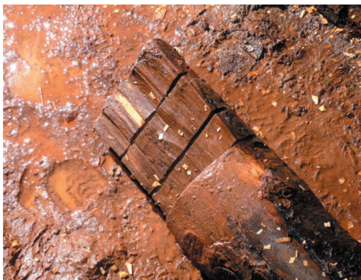
Rys. 8. Fragment obudowy szybiku I przygotowany do pobrania próby dendrochronologicznej
