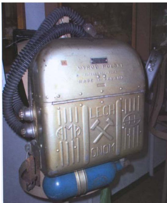
Rys. 3. Aparat ratowniczy GNOM (ze zbiorów Muzeum Górnictwa Węglowego w Zabrzu) Fig. 3. Rescue apparatus GNOM (from collection of Coal Mining Museum in Zabrze)
