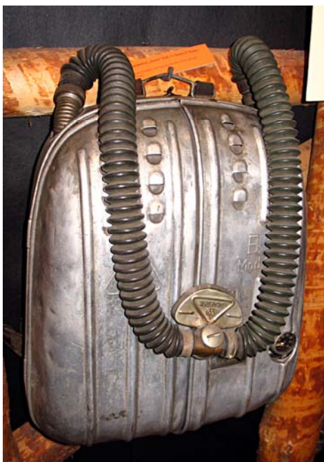
Fot. 2. Aparat ratowniczy Draeger model 160 (ze zbiorów Muzeum Górnictwa Węglowego w Zabrze) Fig. 2. Rescue apparatus Draeger Type 160 (from collection of Coal Mining Museum in Zabrze)
