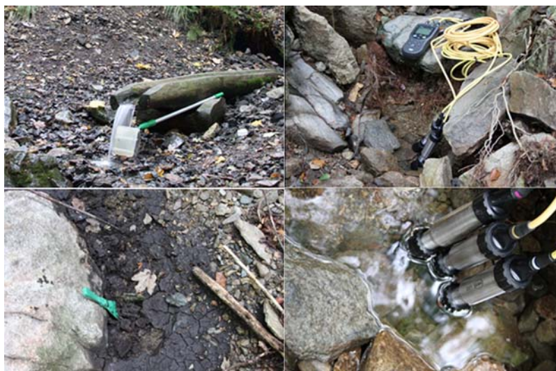
Rys. 1. Opróbowanie i pomiar fizykochemicznych wskaźników środowiska wodnego
