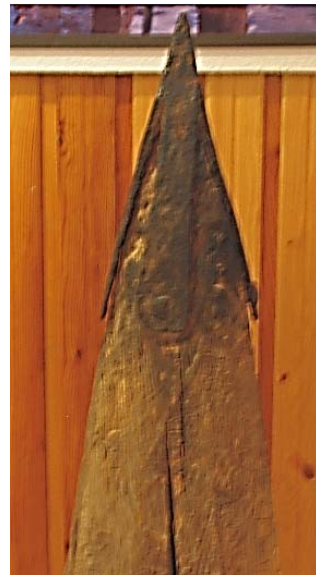
Rys. 6. Widok elementów żelaznych wytworzonych we wsi Huta; a) czop w dnie progu śluzy, b) okucie pała drewnianego Fig. 6. View of iron produced in the village of Huta; a) iron pin in the bottom of the lock threshold, b) ferrule wooden pile
